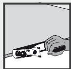
Afbeelding 4: Afwerken van het breukvlak met de schaaf
